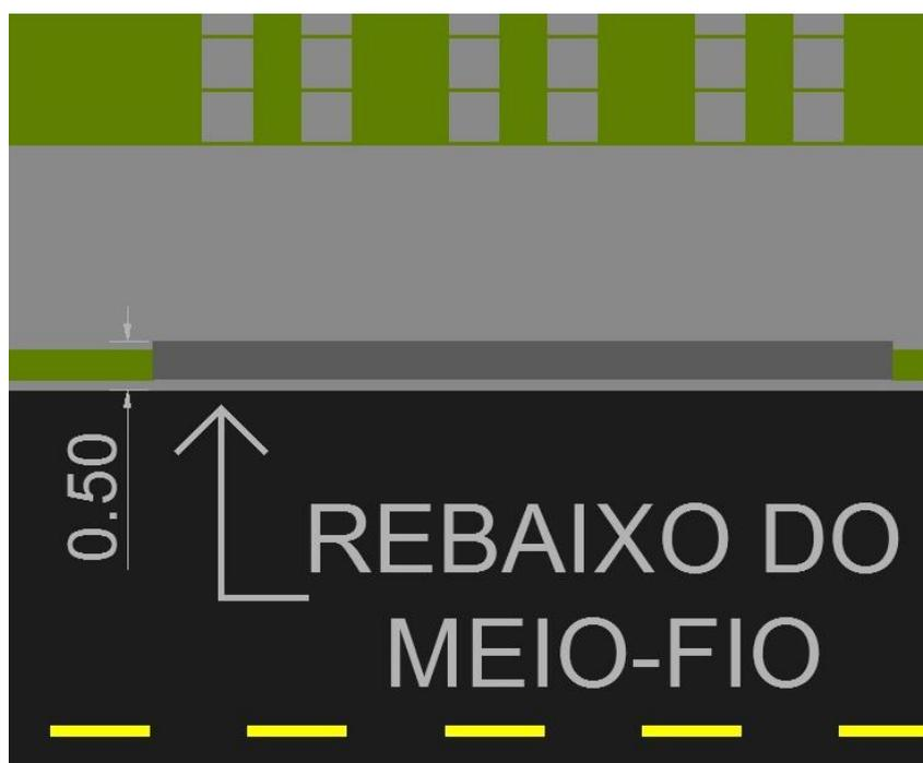
Figura 08: Planta modelo do rebaixo de meio fio para acesso de veículos
